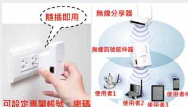
圖 3 無線訊號延伸器與操作原理
