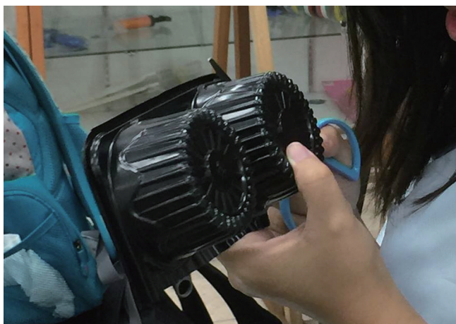
圖九：學生開始改變不同形狀、材質製作發電機組。圖中學生認為受風的風杯形狀和大小會影響效能，重新改裝中。
