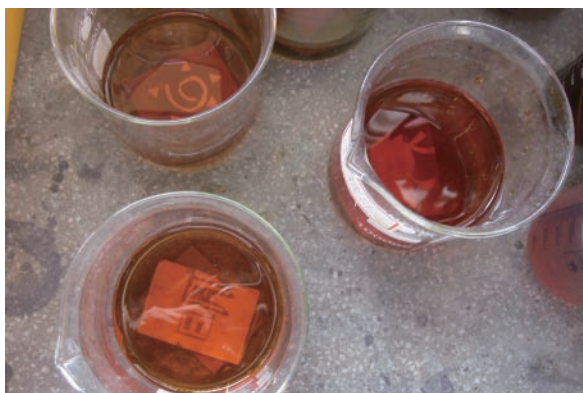
圖十一：雕刻後的銅板浸泡在氯化鐵溶液中。
