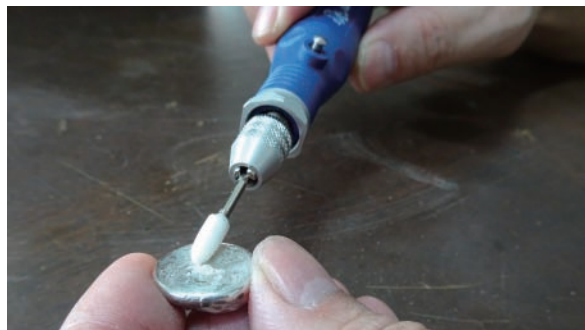
圖十：利用棉布輪安裝在電動工具上，加工拋光。
