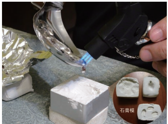
圖三：將熔融的錫金屬倒入石膏模。
