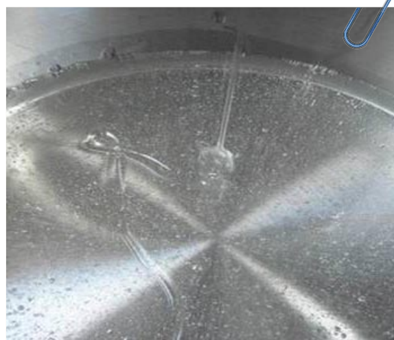
圖4：清潔劑滴下時液面先產生堆積，接著開始彈跳
