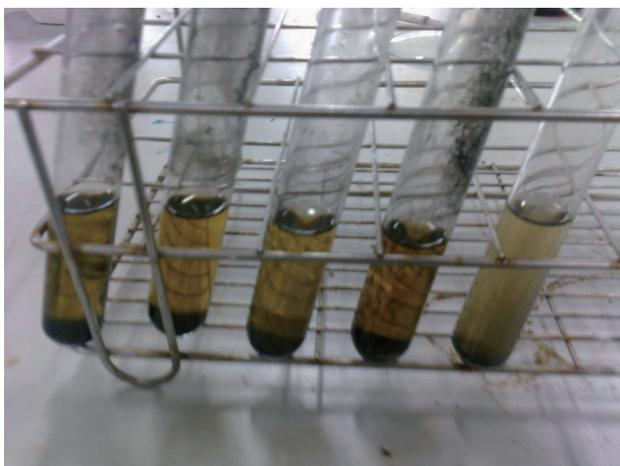
圖十：碳簇溶解在甲苯溶液呈現淡黃褐色
