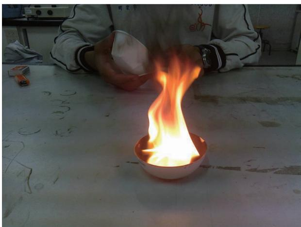
圖十一：燃燒甲苯時的情形，請盡量在通風處進行
