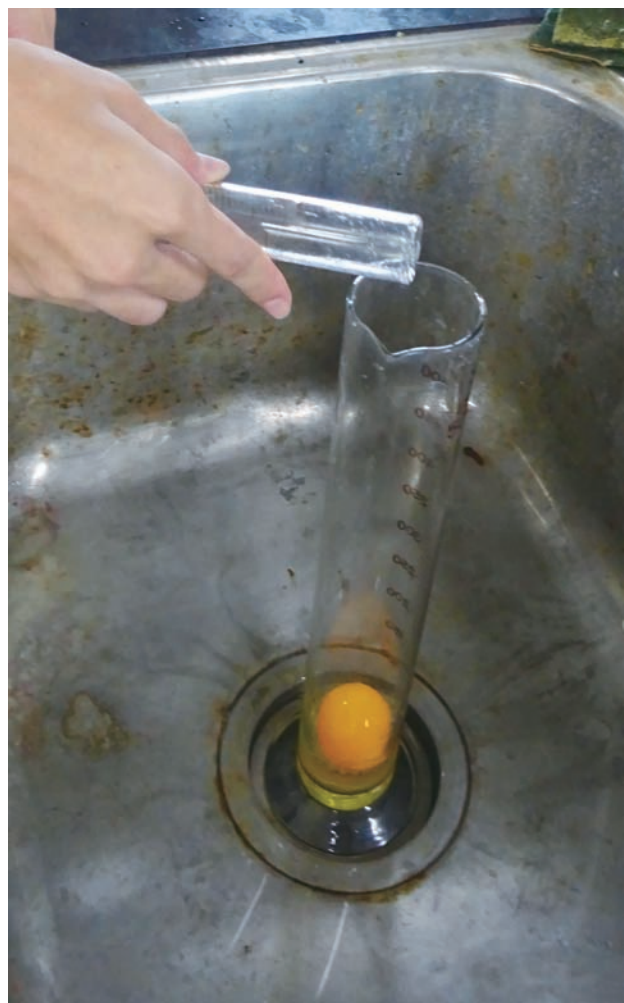
圖一：將乒乓球放入500毫升量筒中再將雙氧水倒入，此時化學反應產生的泡泡會將乒乓球頂至瓶口。
